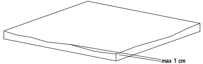
Pour éviter toute infiltration d'eau, la dalle de béton ne doit pas excéder les dimensions de l'abri. Si elle est plus grande, l'eau de pluie ruisselant du toit s'accumulera sur la dalle et s'infiltrera dans l'abri. Dans ce cas, nous déclinons toutes responsabilités en cas d'infiltration d'eau. La dalle ne doit pas avoir plus de 1 cm de défauts de planéité. Le produit doit être à 50cm au moins de tout mur, haie ou grillage afin de permettre son montage et son entretien.
